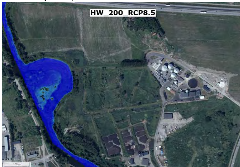
Figur 18. Modellerad 200-årsflödesnivå i Stångån från dagvattenutredningen.
