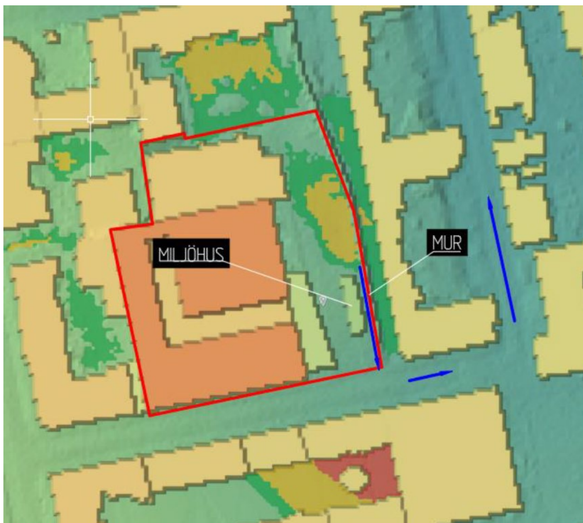
Karta från dagvattenutredning för Badhuset 14 framtagen av AFRY som visar föreslagen skyfallsåtgärd för att låta vatten rinna enligt befintliga markhöjder mot Badhusgatan. Blå pilar visar flödesvägar. Rinnvägarna leder mot Stångån.
