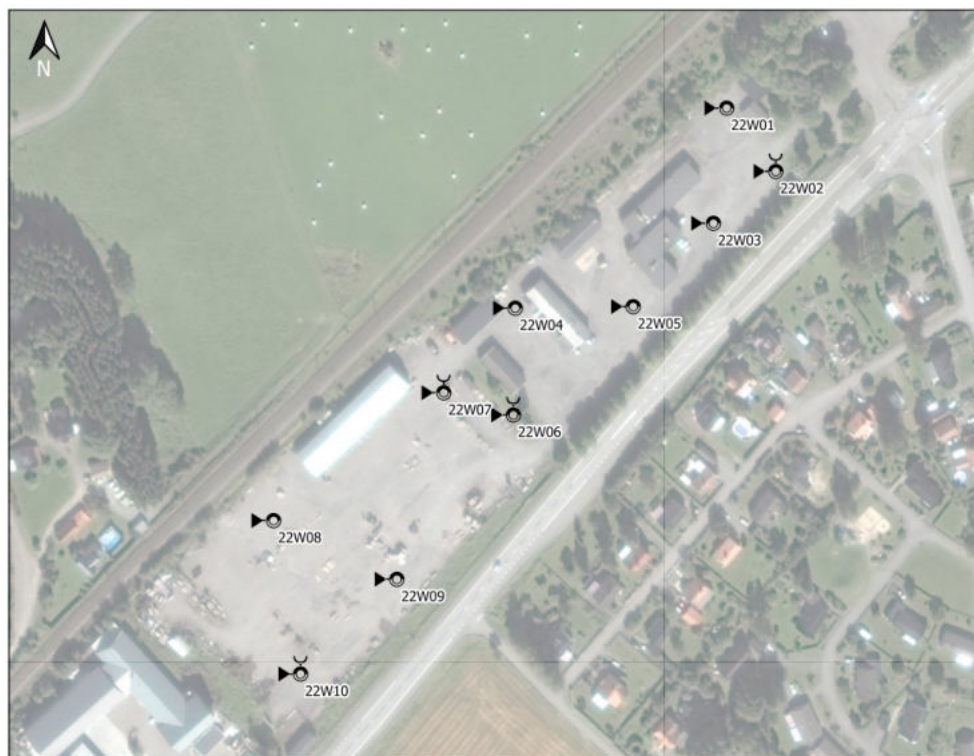
Bild 14: Provpunkter i den miljötekniska markundersökningen (Karta ur Miljöteknisk markundersökning för fastigheten, WSP)
