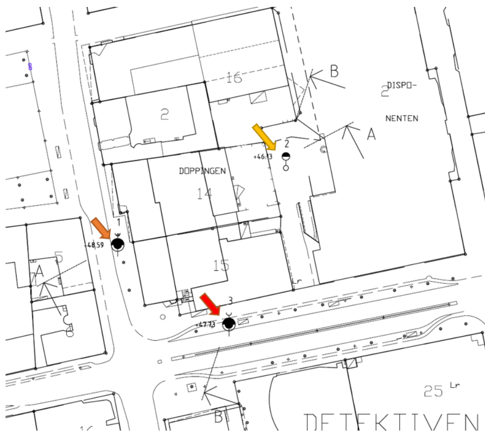
Bild. Borrhål för markprover och grundvattenmätning. Punkt 1 markerad med orange pil i bilden och punkt 2 markerad med gul pil i bilden och punkt 3 markerad med röd pil i bilden. Borrhål 2 utgick på grund av berg (bild framtagen av Tekniska verken).
