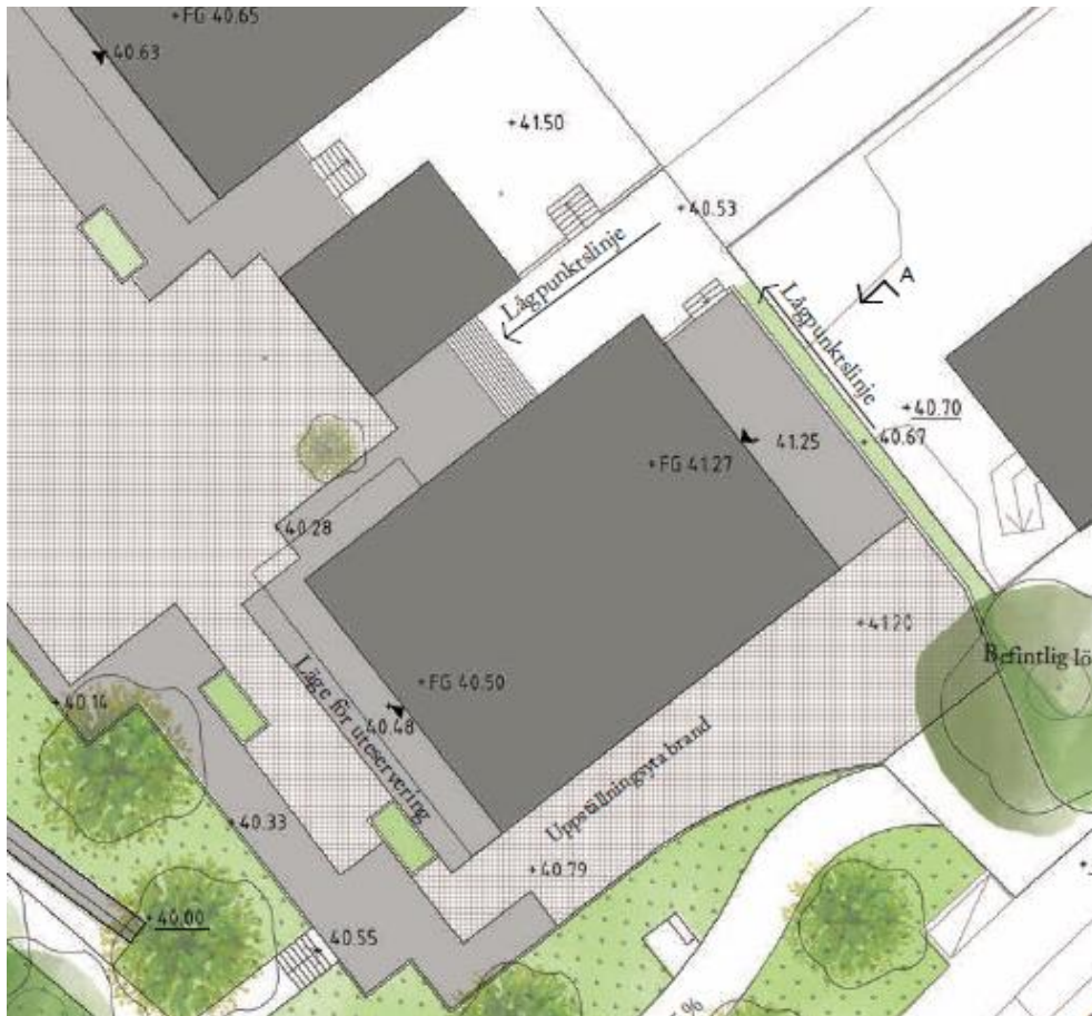
Bild. Illustrationen visar de lågpunkter som behöver säkerställas för att leda ut vatten från kvartersmarken vid stora vattenmängder. (Tyréns, 2020-10-14)
