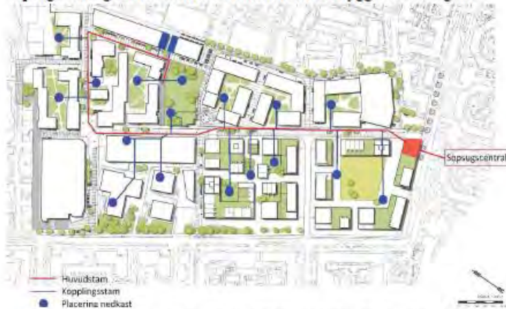
Bilden visar placering av sopsugsnedkast (blå punkter) och dess kopplingar (blå streck) till sopsugens huvudstam (orange) genom området.
