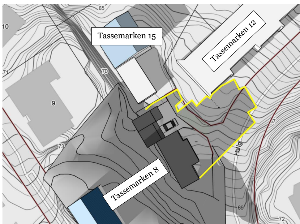
Bild 4. Skuggbildning vid vårdagjämning kl 15. Byggnadsvolymen som redovisas är den största möjliga volymen för att redovisa största möjliga utbredning av skuggning och inte ett faktiskt bebyggelseförslag. Gulmarkering tydliggör utbredning.
