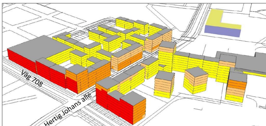
I bilden visas med röd färg vilka fasader längs väg 708 som utsätts för trafikbullernivåer som överstiger riktvärdena 60 dBA ekvivalent ljudnivå (Soundcon, 2019).
